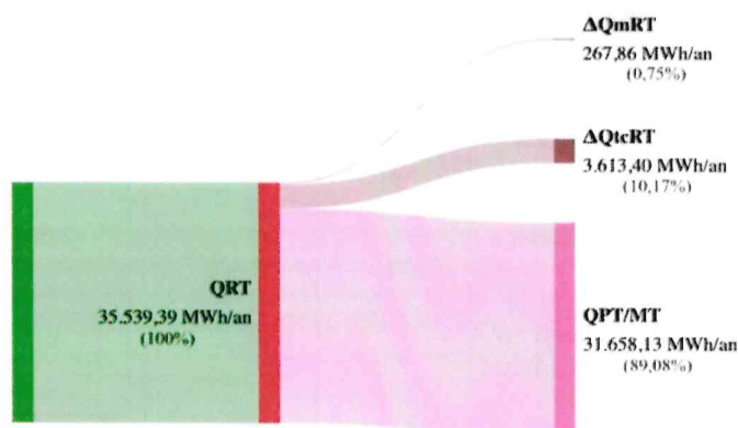
Figura 17.1 – Diagrama Sankey – bilanțul optimizat al rețelei de transport
